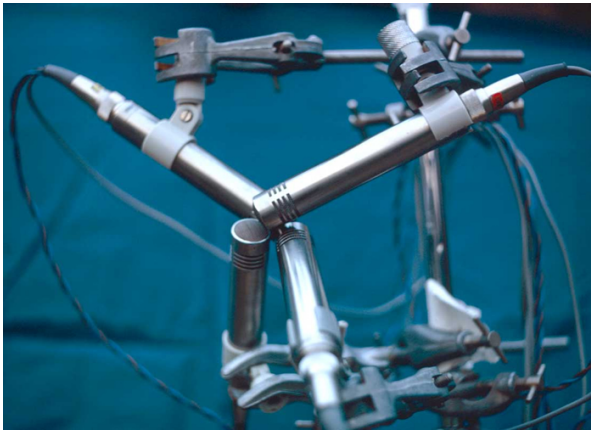
Figure 33.12: Le tétraèdre, monté avec des microphones Calreco, ancêtre des microphones ambisoniques
